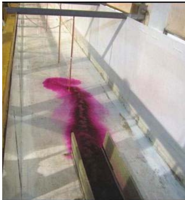
Figura 7. Vertido directo superficial a través de rambla. Ensayos del CEDEX.
