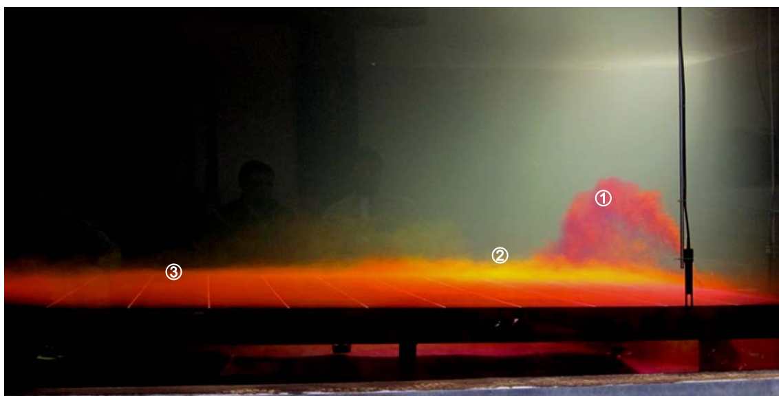
Figura 4. Comportamiento del efluente hiperdenso en caso de vertido mediante chorro individual: campo cercano y lejano. Ensayos realizados en el IH Cantabria
